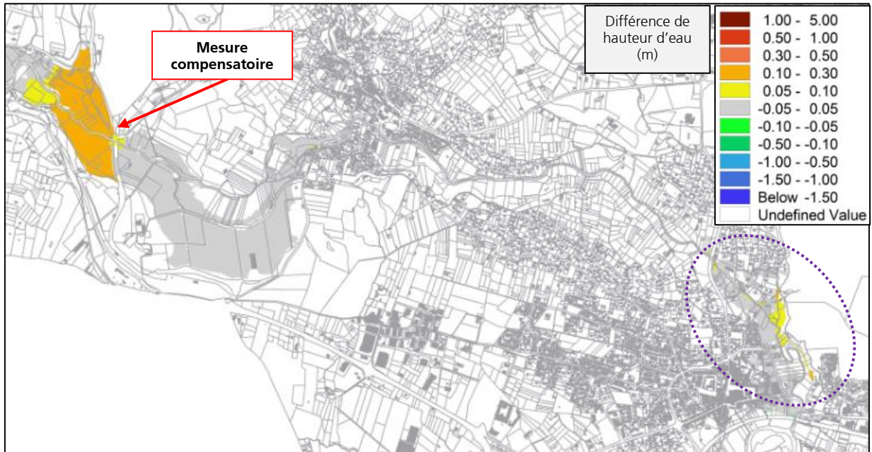
Figure 44 Scénario 2 – Différences de hauteurs d'eau par rapport à la crue trentennale à l'état projeté
